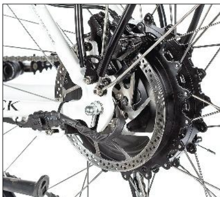
Scheibenbremsen machen beim Pedelec Sinn. Die Technik ist mittlerweile ausgereift.
